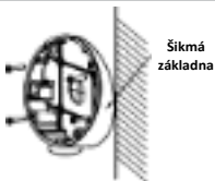
Obrázek 2-12 Upevnění těla šikmé základny na strop/stěnu
