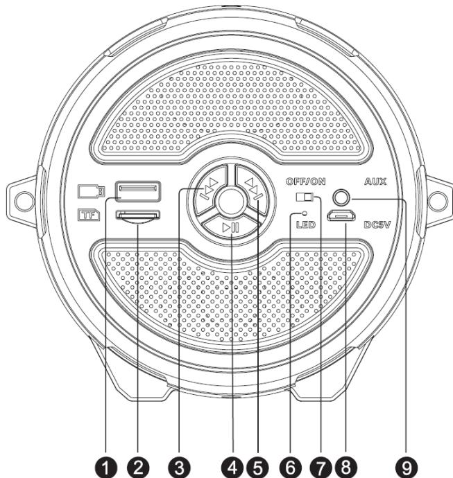
**1.USB slot:** Vložte USB disk se skladbami ve formátu MP3.
