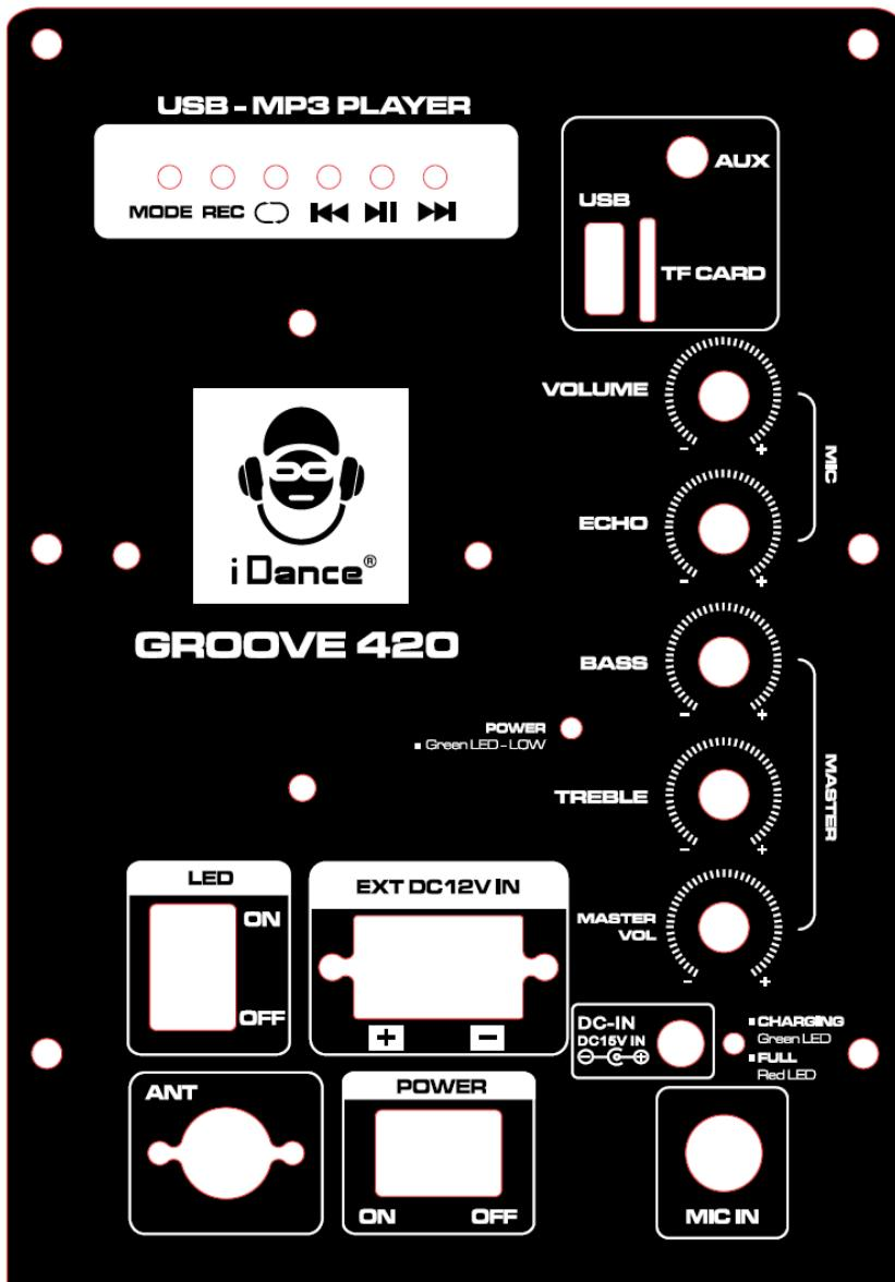
**POWER:** spínač napájení. Po připojení adaptéru je baterie nabíjena nezávisle na stavu hlavního spínače.
