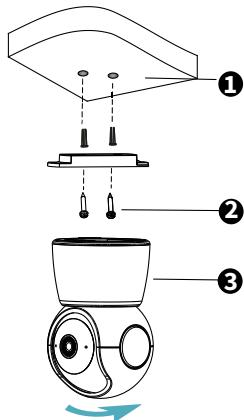
Vyvŕtajte otvory a vložte hmoždinky (1). Priskrutkujte montážnu konzolu (2) a pripevnite kameru (3). 5. Pripojte napájací zdroj a kábel LAN (voliteľné). Na pripojenie použite vodotesnú súpravu.
